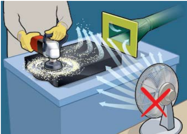
Figure 13 : Influence des courants d'air sur la captation des particules
