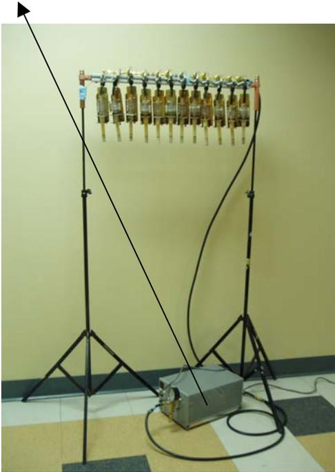
Figure 3 : Montage des trains de prélèvement
