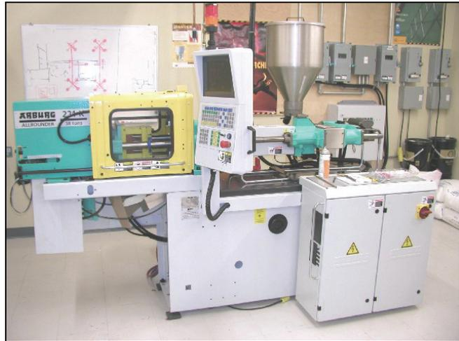
Figure 4 : Presse à injection de l'IRSST
