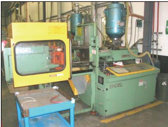
Figure G.1 : Presse à injection de plastique dans l'usine A
