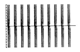
Fréquence du signal = 4 kHz Signal permanent égal au minimum de la gamme de mesure Fréquence du signal = 4 kHz Durée des salves: >= 1 ms
