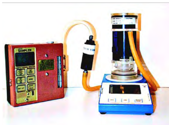
Figure 11- Étalonnage d'un train d'échantillonnage
