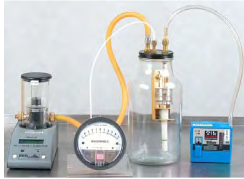
Figure 12- Étalonnage avec un cyclone
