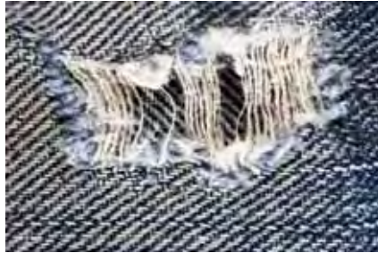
Textile usé par abrasion
