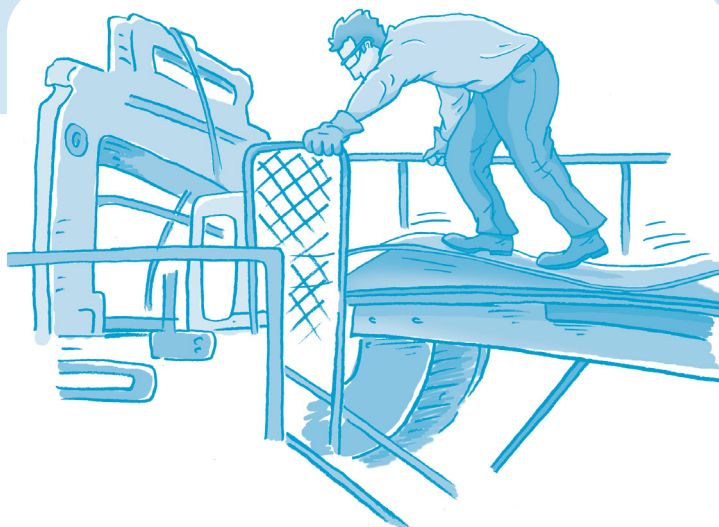
Fig. 2.2 Opérateur montant sur la feuille de métal pour bien l'insérer dans le refendoir.
