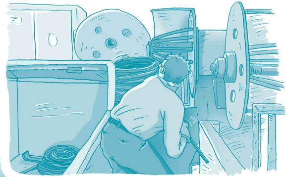
Fig. 2.5 Opérateur devant vider l'enrouleuse dans un espace restreint de travail.
