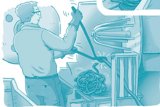
Fig. 2.6 Opérateur devant couper et attacher à nouveau la bande de métal qui s'est décrochée de l'enrouleuse.
