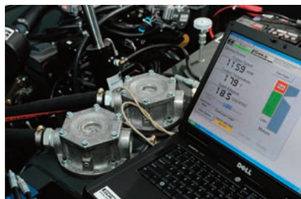
Mesure de concentration des gaz d'émissions entre le moteur et le catalyseur
