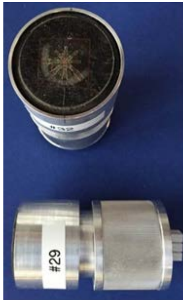
Figure 4.37 – Cellule ou capteur du nouveau MAI comportant une connectique améliorée.
