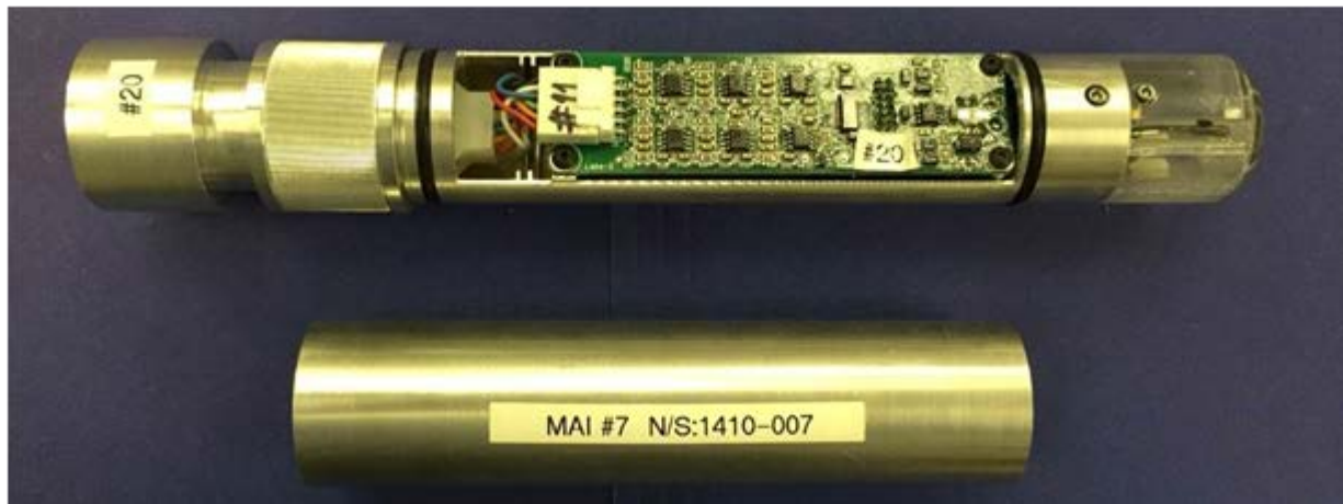
Figure 4.35 – Module ouvert et cylindre de protection. Notez le capteur (#20) fixé au module.
