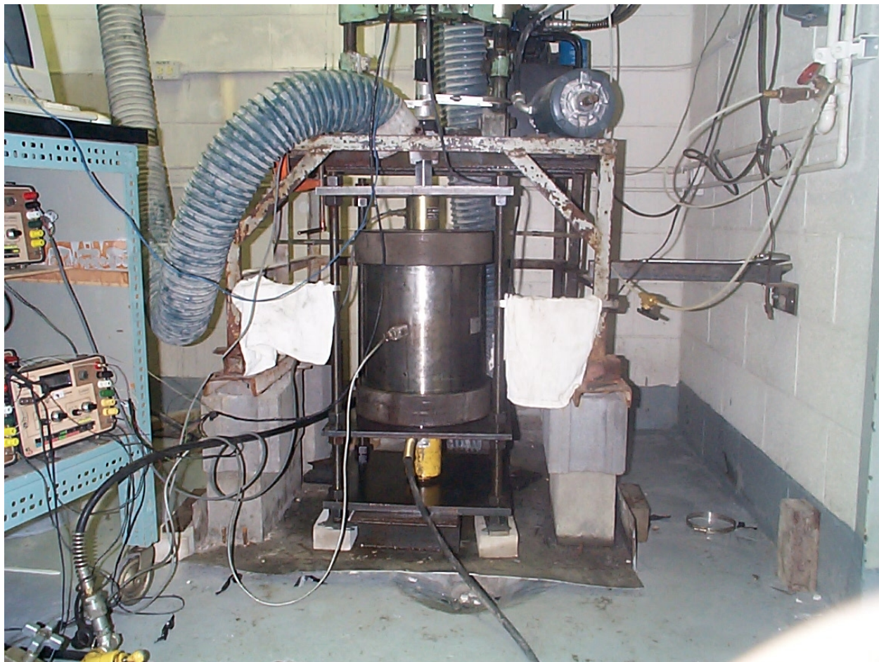
Figure 4.38 – Banc d'essai permettant de réaliser des mesures de contraintes dans un environnement contrôlé.
