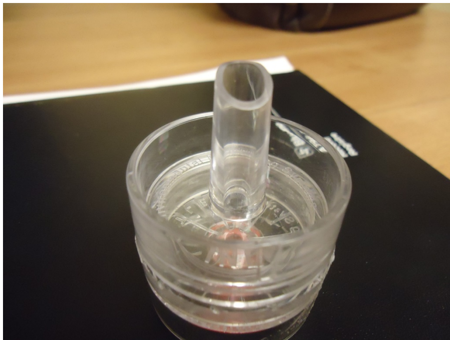
Figure 4 : Cassette de prélèvement des poussières avec bec collecteur biseauté intégré, préparée par EMS.
