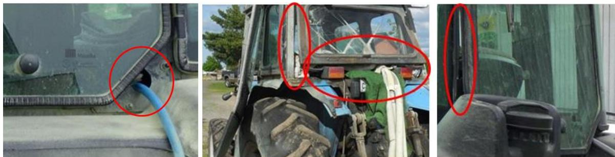
**Figure 10. Tracteurs-cabines non étanches observés sur les exploitations.**
