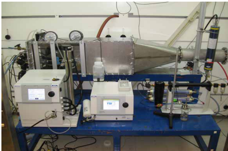
Figure 2.1 – Représentation de l'installation utilisée pour évaluer l'efficacité des APR de type N95 dans des conditions de débit d'air cyclique et constant [81]
