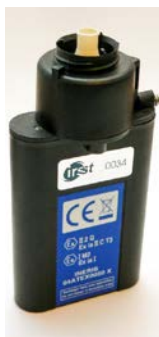
Figure 5 – Configuration du CIP10M utilisée pour l'échantillonnage terrain
