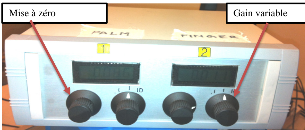
Figure 3.3 : Conditionneur de signal à deux canaux développé pour enregistrer simultanément les signaux des capteurs FlexiForce ® côté doigts et côté paume.
