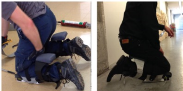
Proto II avec appui-cuisse trop près de la cuisse et Proto III amélioré
