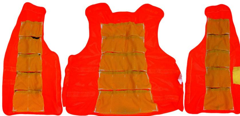
**Figure 3.3** Prototype de veste du volet 1, permettant de contenir les sachets de MCP dans leur forme assemblée.
