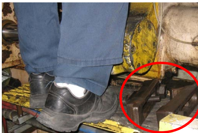
Figure 20 – Travailleur sur le marchepied encombré par des brides de serrage.
