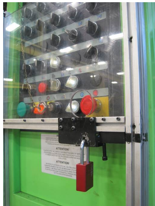
Figure 10 – Condamnation-cadenassage partielle : cadénassage de groupe (1) et du panneau de commande (2).
