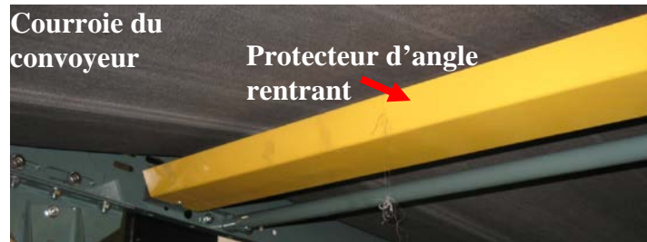
Figure 25 – Protecteur d'angle rentrant, installé sur un rouleau porteur du convoyeur.
