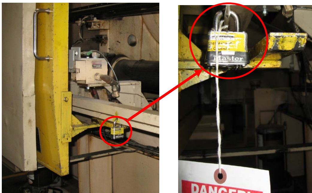
Figure 8 – Condamnation-cadenassage partielle : le cadenas bloque le protecteur de l'opérateur sur son rail.
