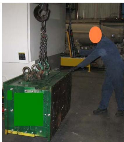
Figure 12 – Exemple de manutention d’un moule avec un pont roulant.
