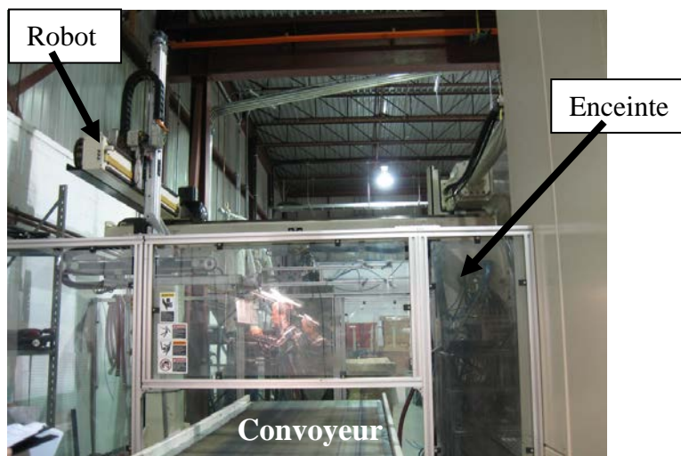
Figure 24 – Enceinte de protection abritant le robot et la partie du convoyeur ayant un angle rentrant accessible.
