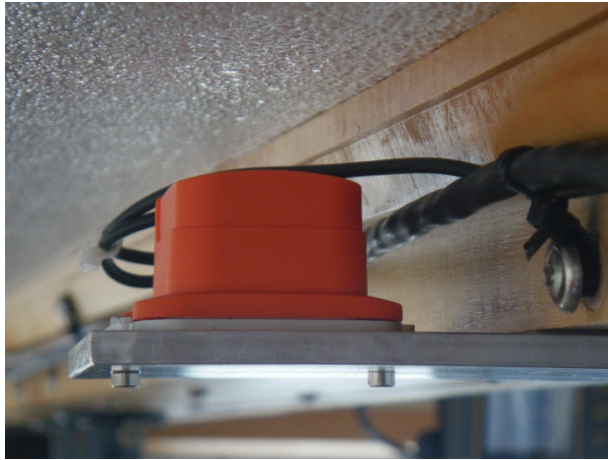
A. Centrale inertielle, fixée au plafond de la timonerie de chacun des deux crabiers.
