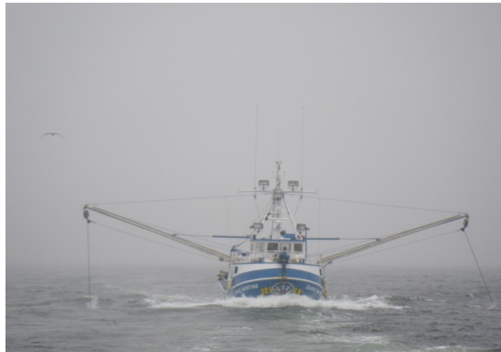
Figure 1. Système d'amortissement du roulis à paravanes.
