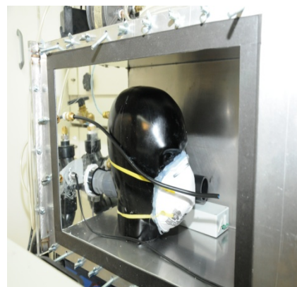
Figure 2-5 : Photographie du masque de protection respiratoire N95 scellé sur le mannequin
