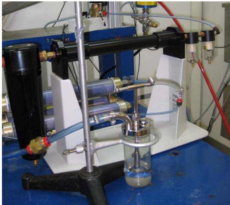
Figure 2-9 : Photographie du dispositif d'alimentation en air filtré (modèle 3074, TSI Inc.) relié à un nébuliseur Collision à six jets
