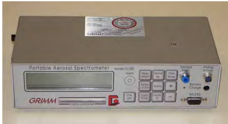
Figure 4.1-2: GRIMM PAS 1.108 Spectrometer
