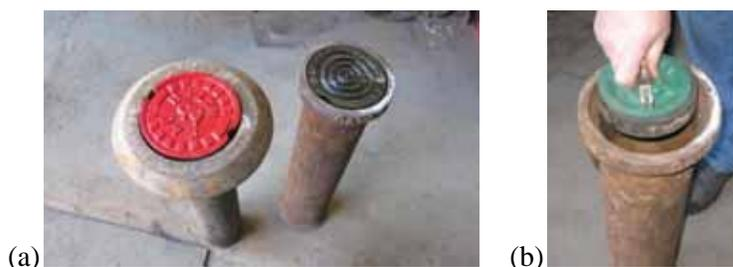
**Figure 21 – (a) Bouchon de vanne de rue peinturé en rouge, (b) Dispositif testé pour la condamnation du conduit d'accès aux vannes de rues**
