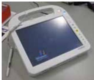
**Figure 20 – Tablette PC Wifi à écran tactile utilisée pour accéder aux fiches de cadenassage**
