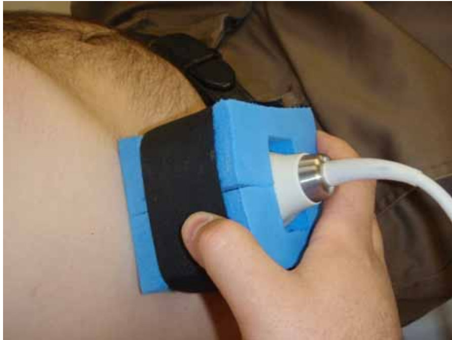
Figure 2 : Cube de mousse à haute densité (3 × 3 × 3 pouces) dans lequel la sonde est immobilisée à l'aide d'une bande velcro (effet de ceinture autour du cube). Cela permet de diminuer les variations d'inclinaison et de pression sur la sonde.
