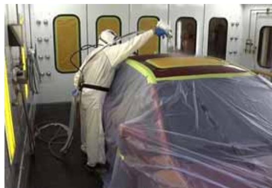
Figure 19 : La posture de travail d'un peintre sur de l'application de peinture sur une surface horizontale (toit), à l'aide d'un pistolet standard.
