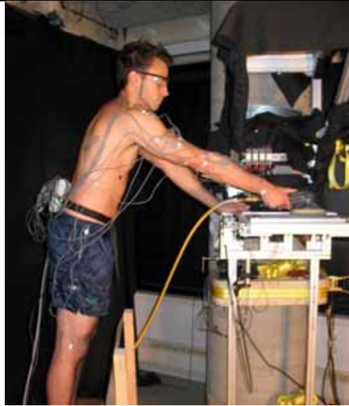
Figure 14 : Représentation d'une condition expérimentale où le sujet ponçe le toit avec des hauteurs modifiées.
