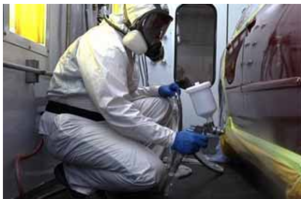
Figure 18 : La posture de travail d'un peintre lors de l'application de peinture sur une surface verticale (portière) à l'aide d'un pistolet standard.
