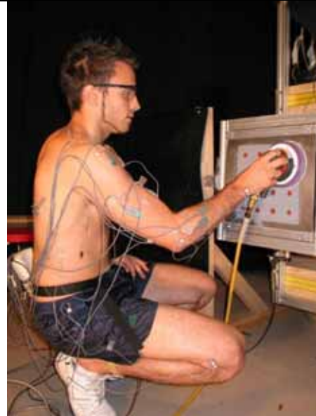
Figure 15 Représentation d'une condition expérimentale où le sujet ponçe le bas de porte avec des hauteurs modifiées.
