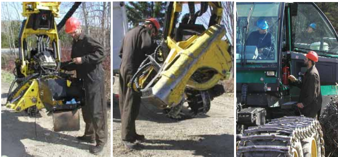
Figure 9 : Calibrage des pressions des actionneurs hydrauliques
