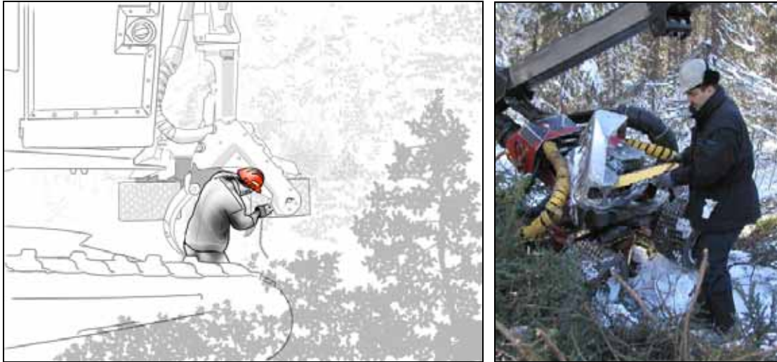
Figure 6 : Opérateur debout travaillant sur la tête suspendue à environ 1 mètre du sol, avec les pinces vers le bas (gauche) ou la tête posée au sol (droite)
