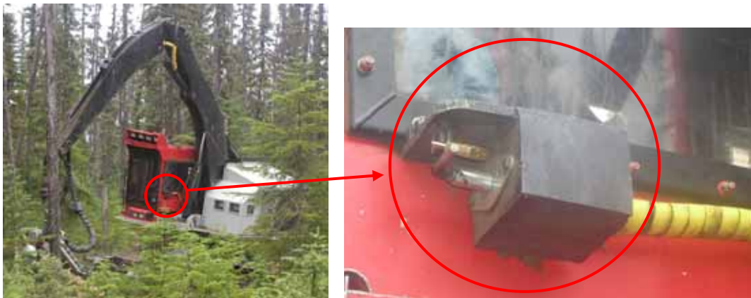
Figure 12 : Sectionneur situé à l'extérieur de la cabine, sans accès prévu
