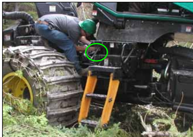
Figure 10 : Sectionneur hydraulique principal sous l'avant de la cabine
