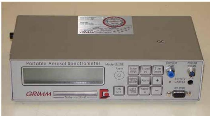
**Figure 4.1-2 : Spectromètre GRIMM PAS 1.108**
