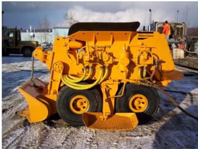
Figure 6. Rétrocaveuse sur roues CAVO310
