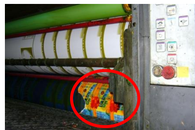
Figure 5 : Bout de papier collé (dans le cercle) sur un blanchet
