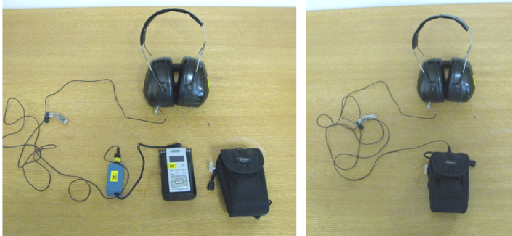
Figure 9 : Aperçu du système de mesures complet connecté à la coquille droite d'un serre-tête (l'image de droite montre le système complet, tel que pouvant être installé à la ceinture d'un travailleur)
