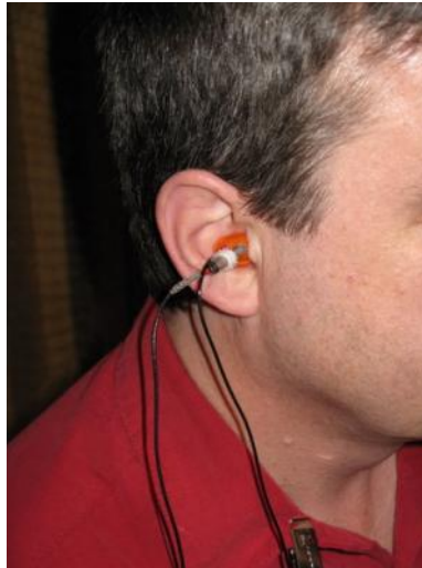
Figure 7 : Aperçu d'un bouchon moulé, instrumenté du doublet microphonique, tel qu'inséré dans l'oreille d'un sujet.
