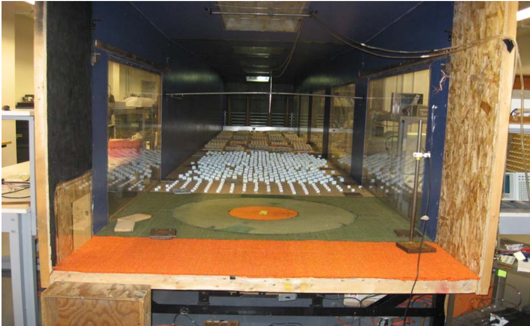
Figure 4.1 Vue frontale de la soufflerie à couche limite de l'Université Concordia
