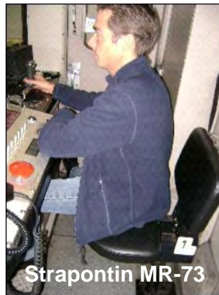
Figure 51. Déplacement de l'opérateur sur le strapontin MR-73 pour se rapprocher du manipulateur en CM (5 e centile)
