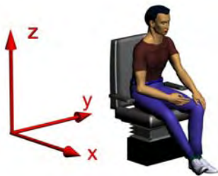
Figure 6. Système de coordonnées basocentrique selon la norme ISO 2631-1 (1997)
