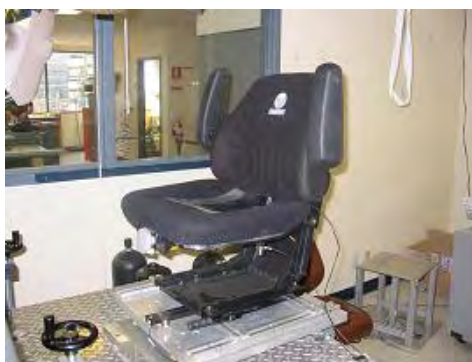
Figure 16. Siège à suspension mécanique au dossier avec son assise originale (D)
