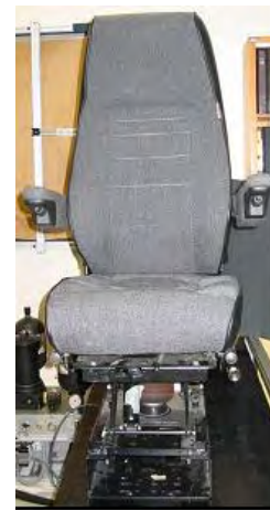
Figure 12. Siège-R, à suspension pneumatique, servant de référence
