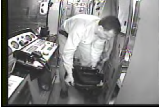
Figure 40. Posture pour ajuster la hauteur du strapontin MR-73
