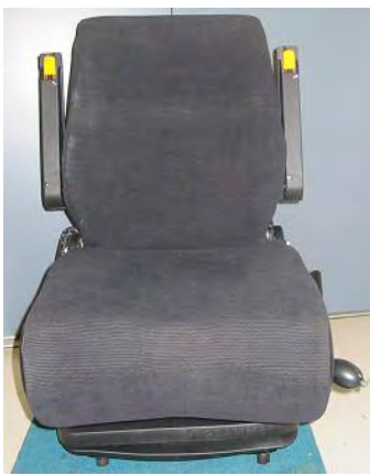
Figure 11. Siège-A, avec suspension mécanique, du fournisseur-1
