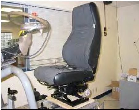
Figure 14. Suspension mécanique (F), compacte pivotée de 90 degrés, assise-R
