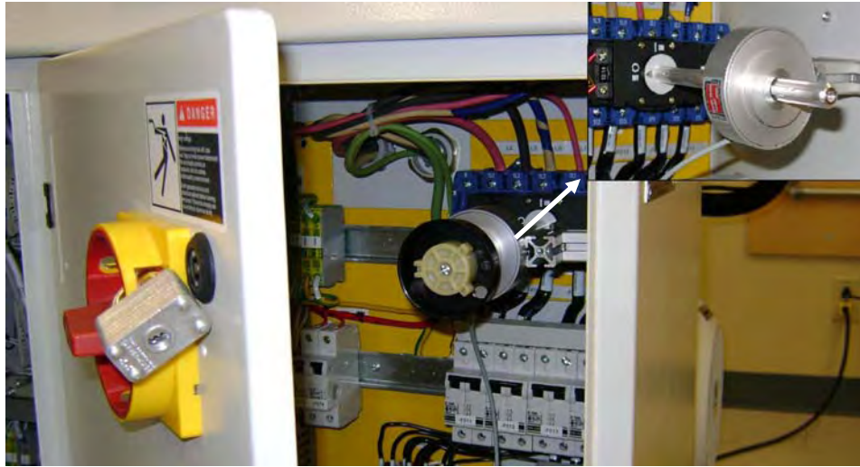
Figure 21: Potentiomètre rotatif intégré au sectionneur de la presse à injection
