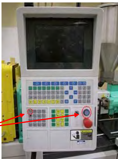
Figure 13: Boutons de démarrage et de réarmement identifiés sur le pupitre des commandes
