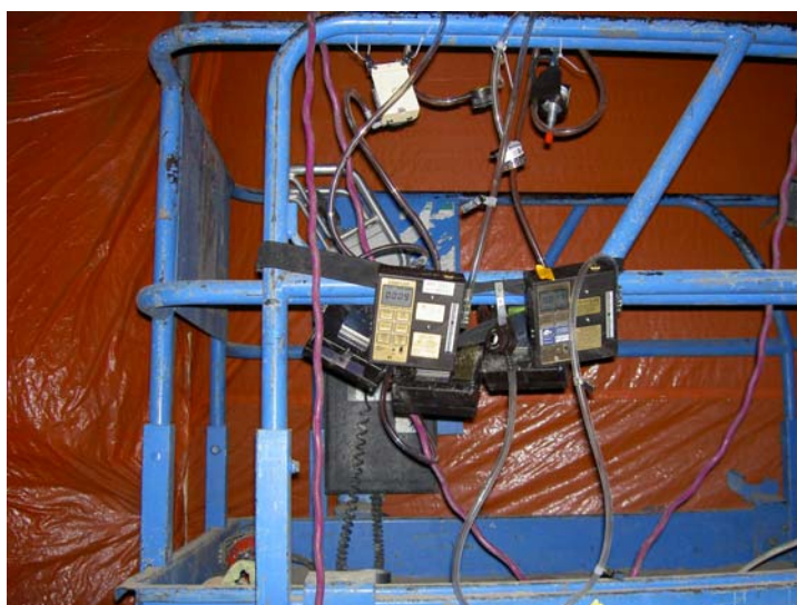
Figure 14 : Poste ambiant avec collecteurs attachés à la nacelle
