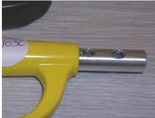
**Figure 13 : Embout Venturi**
