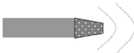
**Figure 15 : Principe d'un silencieux diffuseur**
