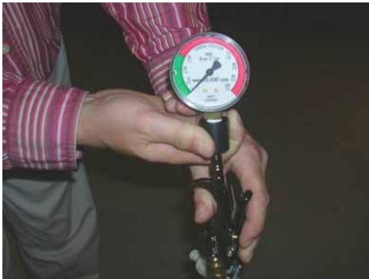
**Figure 3: Mesure de la pression de sortie bloquée**
