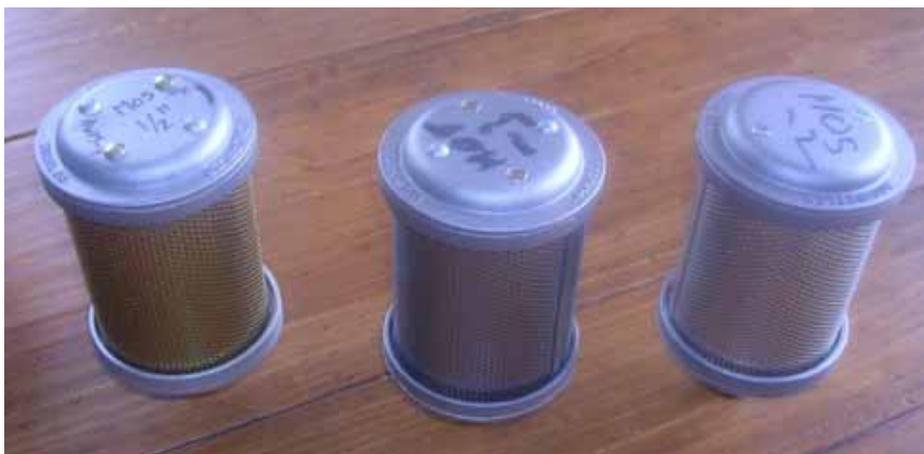
**Figure 6 : Trois silencieux Alwitco M05 respectivement (gauche –droite) de 1995 @ 90.3 dB(A), 2006 @ 81.4 dB(A) et 2010 @ 83.3 dB(A).**
