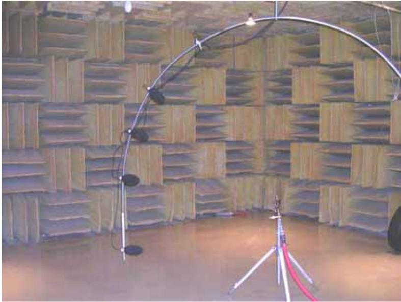
**Figure 1 : Antenne rotative dans la chambre anéchoïque du GAUS + soufflette au centre**
