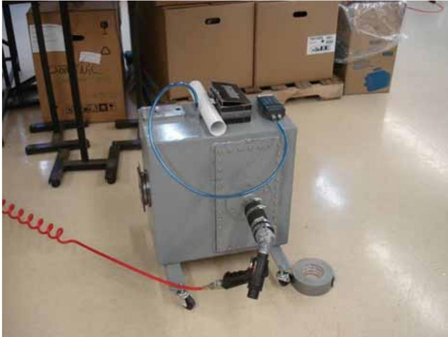
**Figure 5: Banc de mesure de la puissance d'aspiration en air-Watt (Venmar Ventilation)**
