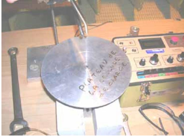
**Figure 2: Dispositif de mesure de la force de poussée (disque de 20 cm)**
