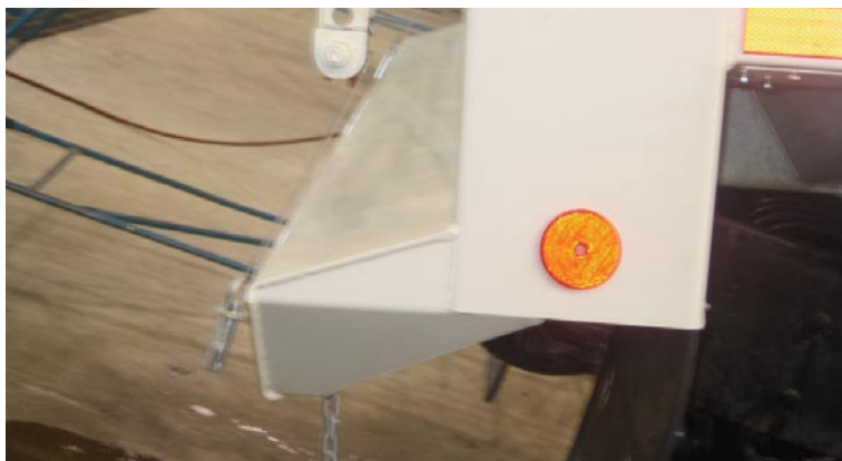
PHOTO 5 PARE-CHOC ARRIÈRE À 45°
