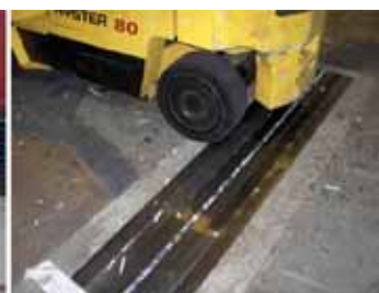
Figure 18 : Passage sur rail faisant lever les roues
