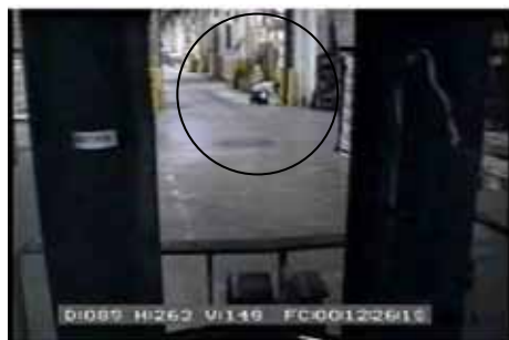
Figure 26 : Détection d'un travailleur accroupi
