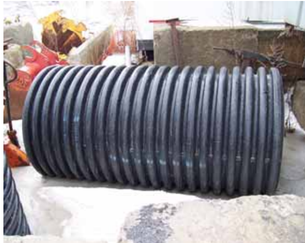
Figure 12 - Le tuyau en polyéthylène haute densité (PEHD) (Source : Lan et al, 2003)
