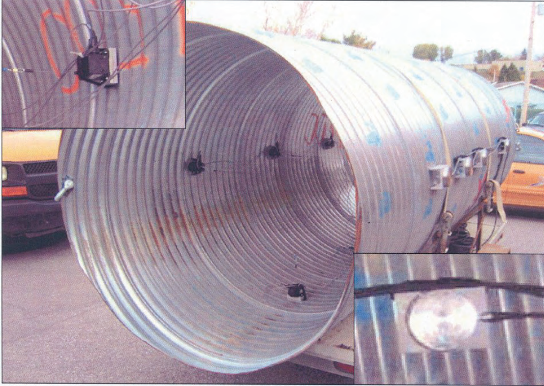
Figure 3.11 Spécimen d'essai en chantier et disposition des LVDT.
