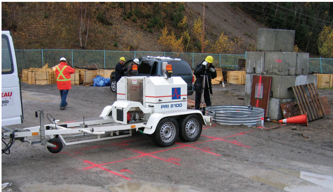
Figure 4.2 Configuration des essais de chargement à l'aide du FWD.
