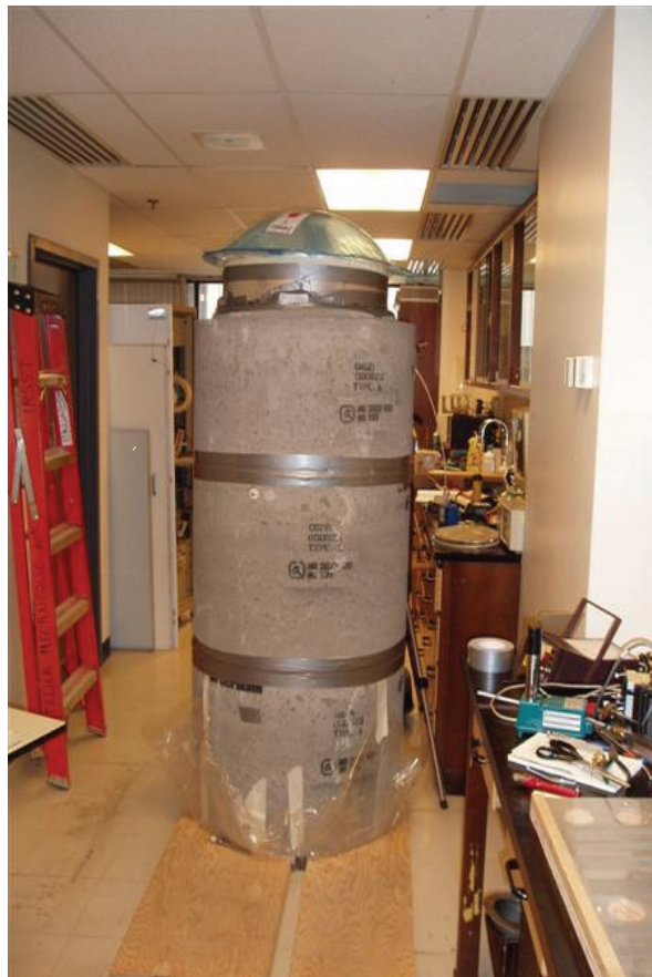
Figure 1 : Prototype de silo à échelle réduite
