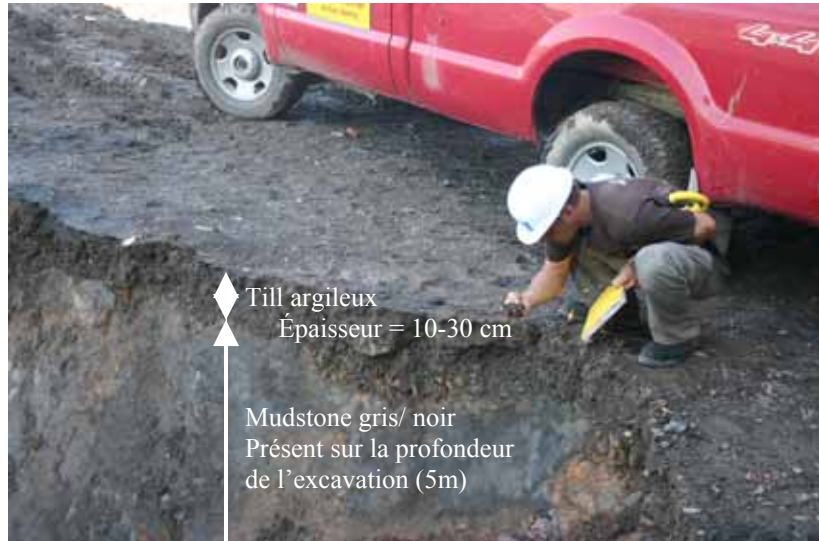
Figure 9 : Examen du till silteux recouvrant le mudstone gris noir de la formation de Sainte-Foy
