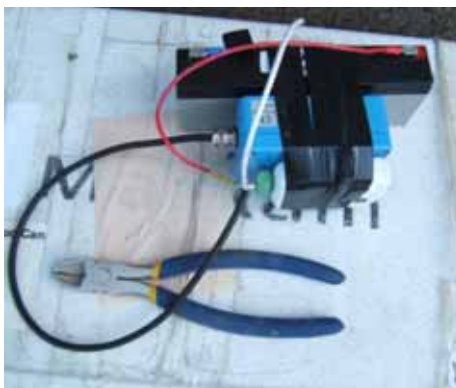
Figure 6 : (a) Appareil BaroLufft pour les mesures de pressions absolues dans l'air ambiant et extérieur (b) Appareil PX-30DI pour des mesures de pressions différentielles dans les puits.
