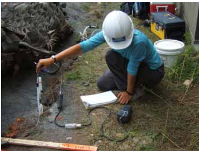
Figure 4 : (a) Prise de mesure de concentration en CO dans un puits avec un détecteur MONOXOR II (b) détecteur MONOXOR II
