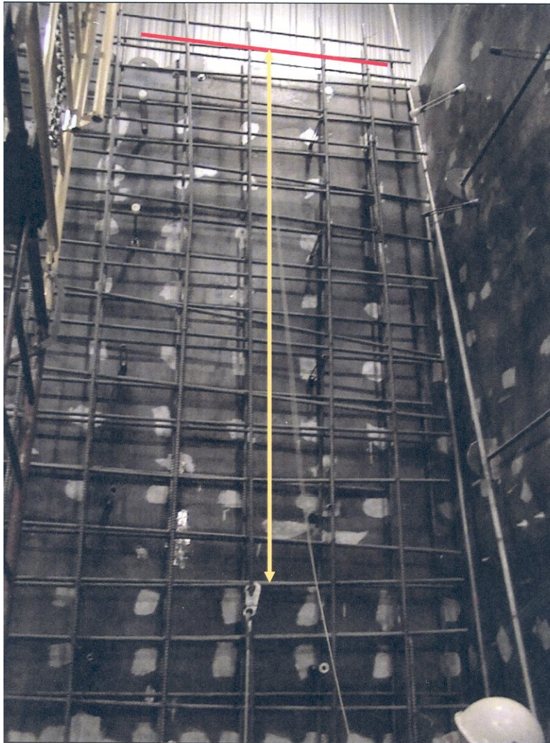
Figure 21 : Chute complète de la masse d'essai lors de l'essai de résistance C
