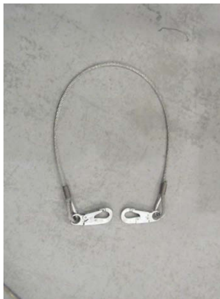
Longe faite d'un câble d'acier de 3/8 pouce de diamètre et 1,5 m de longueur
