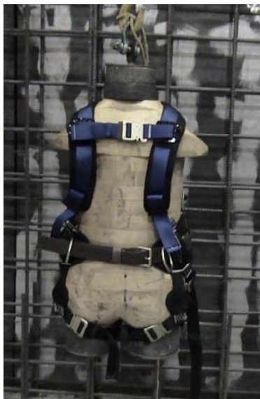
Torse de bois et plomb de 100 kg et harnais classe AP– Vue sternale
