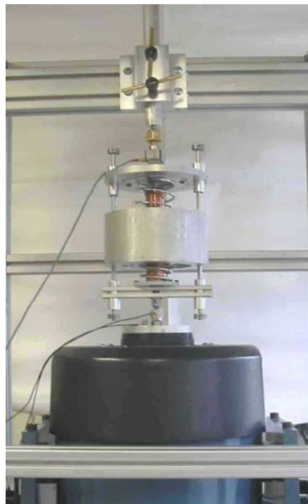
Figure 4. Prototype du mécanisme de substitution à 2 degrés de liberté monté sur l'exciteur électrodynamique.
