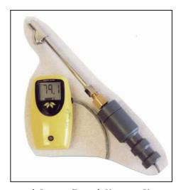
Figure 5.3.6-10 Capteur de pureté du gonflage à l'azote d'un pneu [156]
