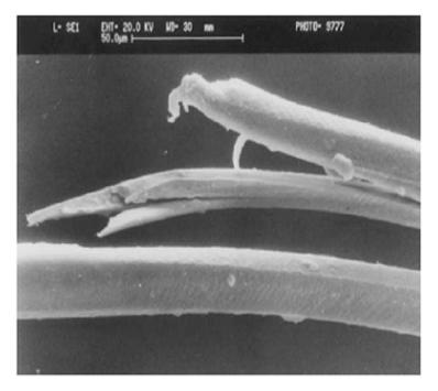
Figure 3.3-1 Image en microscopie électronique d'un filament en polyester après rupture du type fatigue (reproduit de [47])
