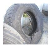
Figure 5.1.1-2 Photos des pneus détruits par un arc électrique sur un fardier
