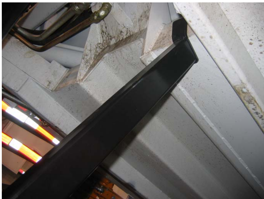
Photo 2. Patte de soutien renforcée pour benne pleine
