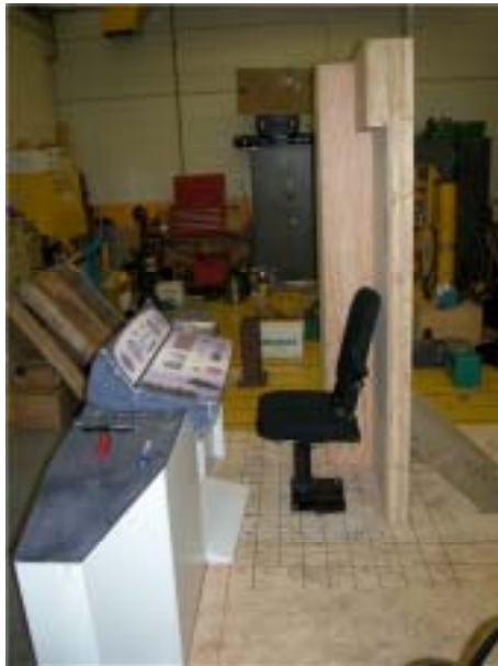
Figure 3.3 Maquette du pupitre fabriquée en carton mousse et installation pour les simulation
