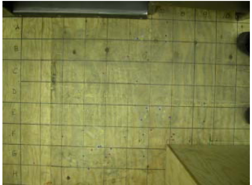
Figure 3.4 Projection des repères de la chaise au sol marquée au moyen de collants de couleur annotés
