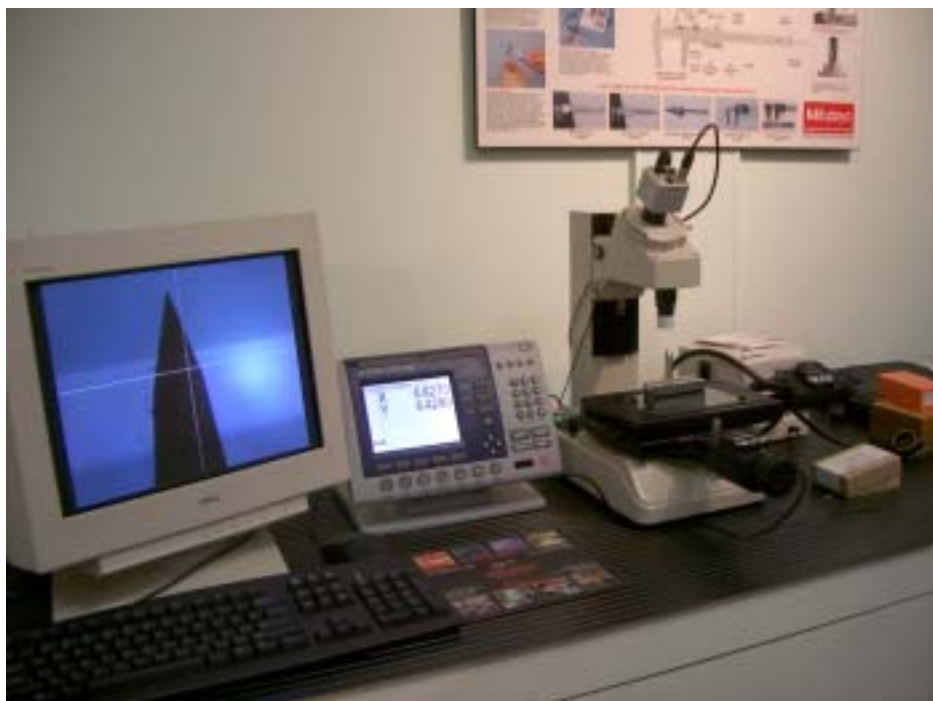
Figure 2.8 Microscope 2D de Mitutoyo servant à caractériser la géométrie de la lame
