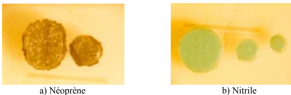
Figure 3.14 Images des pièces de matériaux coupés lors des essais de perforation avec des sondes cylindriques à tête plane des différents diamètres (par microscope 20x)
