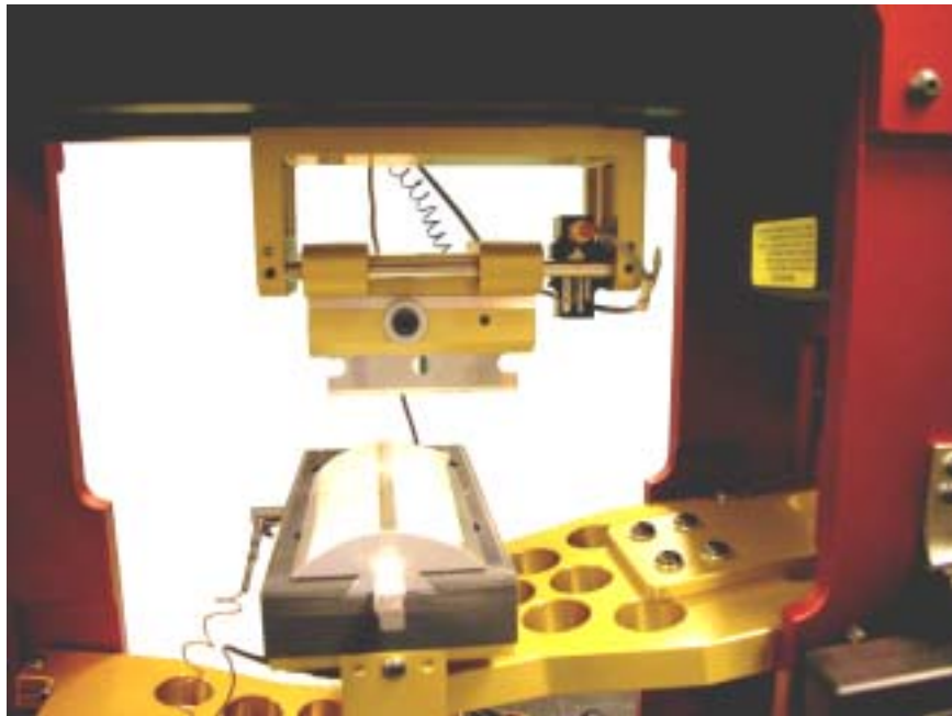
Figure 2.3 Support de lame incluant un capteur de force pour mesurer la force horizontale de friction
