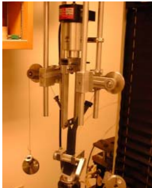
Figure 2.6 Schéma du principe de la méthode coupure de Lake & Yeoh (à gauche) et photo du montage expérimental (à droite)
