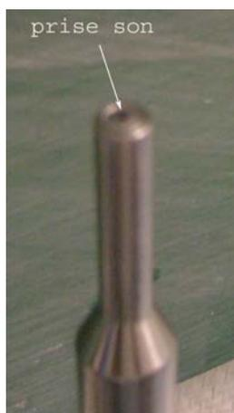
**Figure 20 : Zoom de la prise de pression du micro KE4-211-2**
