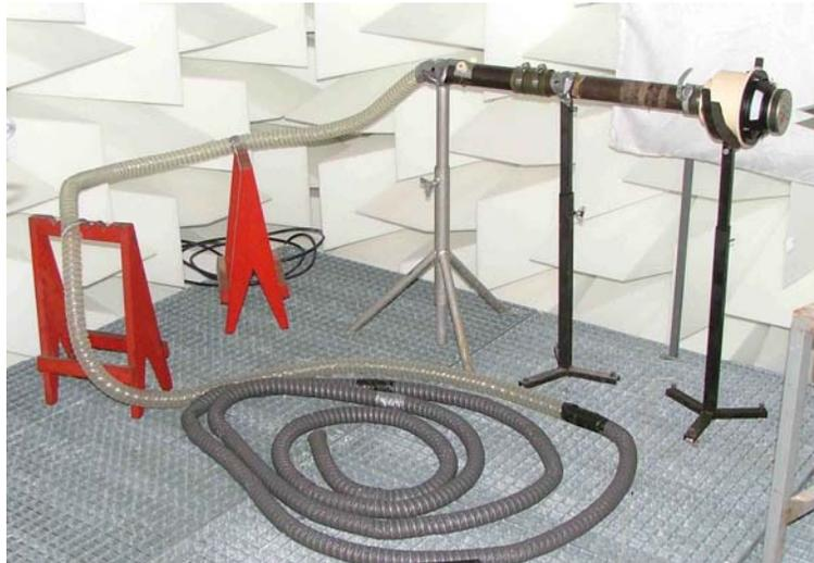
**Figure 15 : Tube à terminaison anéchoïque**
