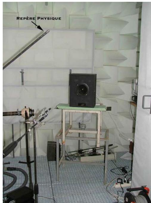
Figure 24 : Montage pour la mesure d'intensité comparative
