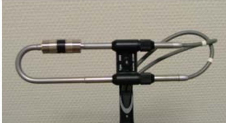
**Figure 7 : Sonde d'intensité développée par B&K**
