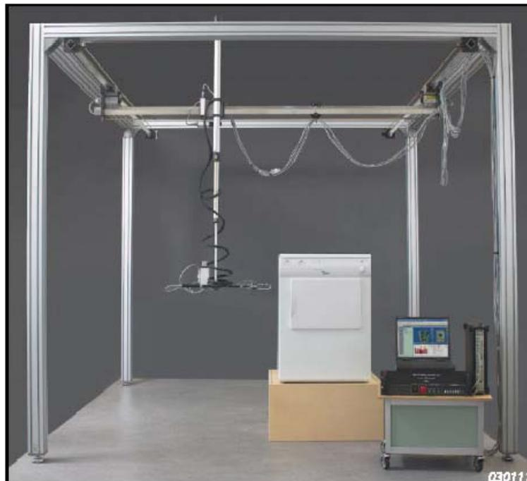
Figure 36 : Sonde d'intensité avec guidage robotisé (source: [10])
