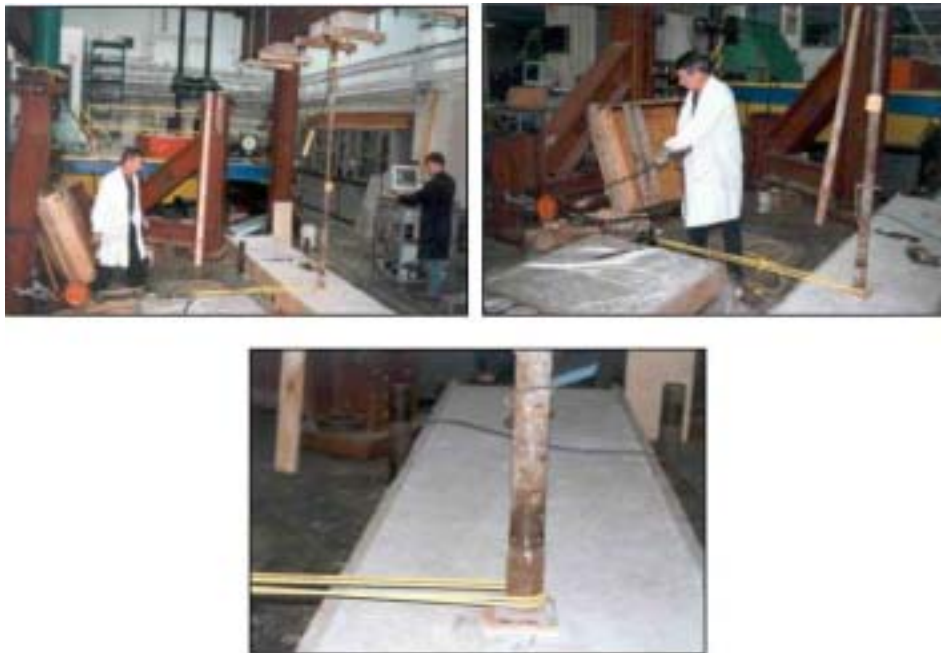
Figure 42 : Mesure du coefficient de friction de l'étau sur la dalle pour l'essai 6-2
