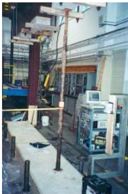
Figure 44 : Essai statique sur un montant (essai 6-3)
