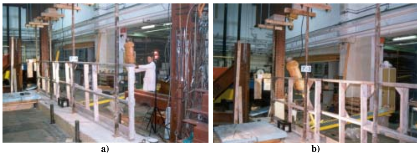
Figure B.23 Essai 7-3 : Essai dynamique sur la lisse supérieure de la section de rive d'une suite de trois sections de garde-corps en bois
