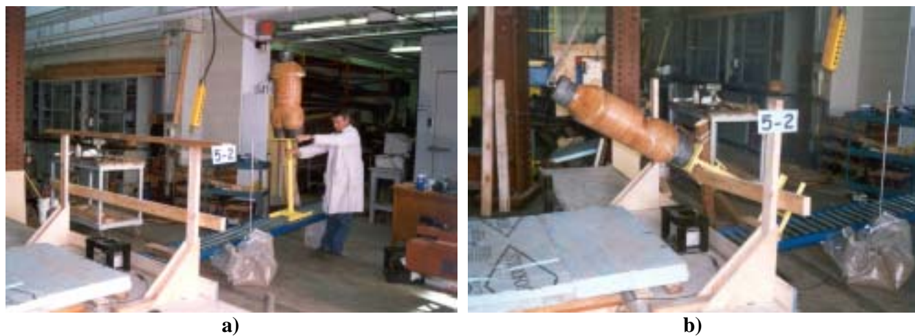
Figure B.12 Essai 5-2 : Essai dynamique sur la lisse supérieure d'une section de garde-corps en bois
