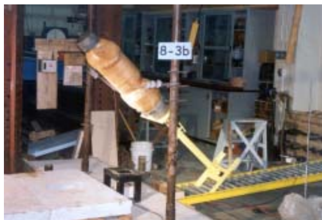
Figure B.30 Essai 8-2c : Essai de basculement avec lisse supérieure composée d'un câble de polypropylène situé à une hauteur de 0,9 m
