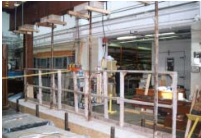
Figure 48 : Essai statique de la section centrale d'une suite de trois sections de garde-corps (essai 6-6)
