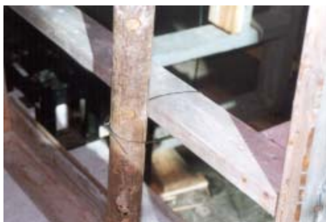
Figure B.19b) Essai 6-5 : Essai statique sur la lisse supérieure de la section de rive d'une suite de trois sections de garde-corps
