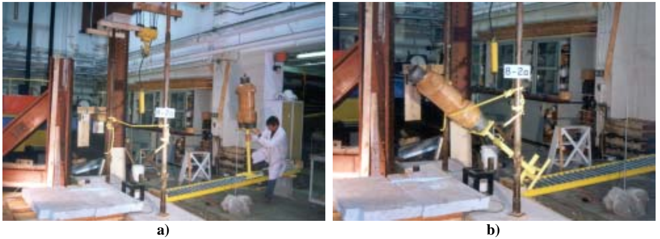
Figure B.28 Essai 8-2a : Essai de basculement avec lisse supérieure composée d'un câble de polypropylène situé à une hauteur de 1.1 m
