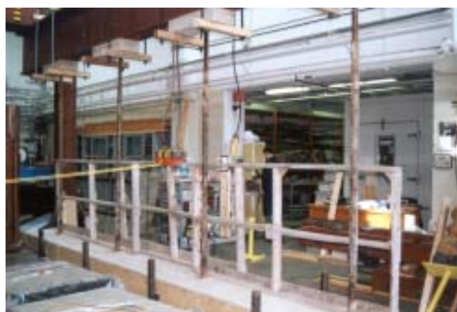
Figure B.20 Essai 6-6 : Essai statique sur la lisse supérieure de la section centrale d'une suite de trois sections de garde-corps
