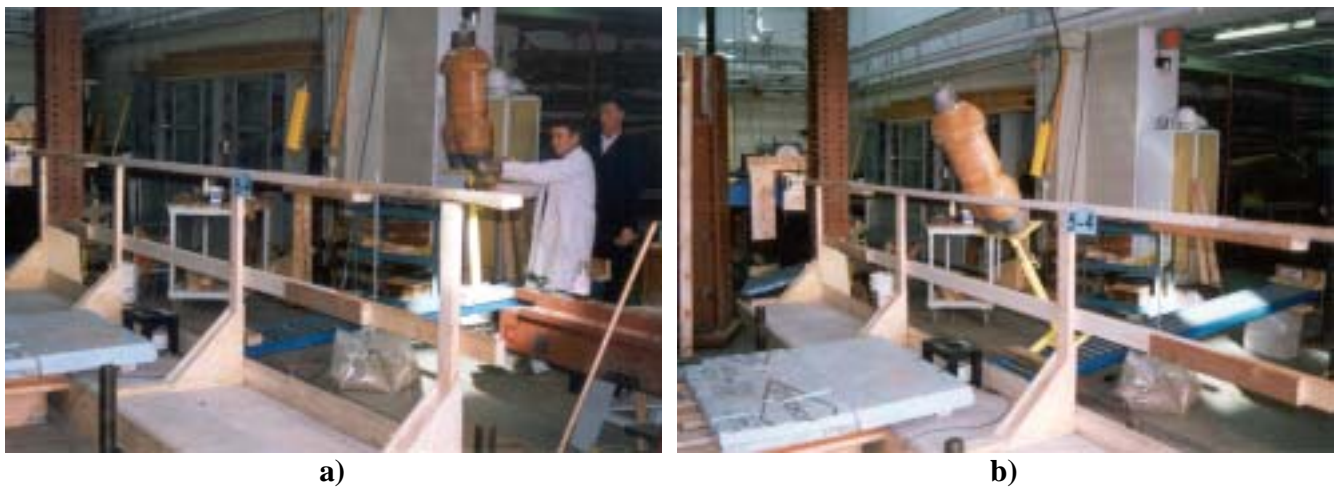
Figure B.14 Essai 5-4 : Essai dynamique sur la lisse supérieure de la section centrale d'une suite de trois sections de garde-corps en bois
