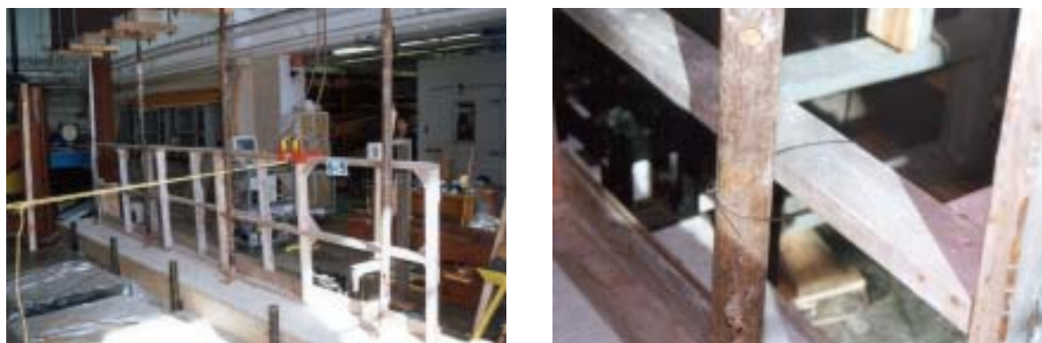
Figure 47 : Essai statique de la section de rive d'une suite de trois sections de garde-corps (essai 6-5)
