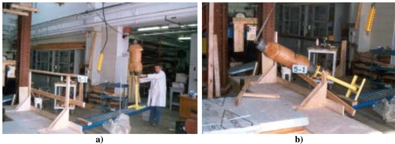
Figure B.11 Essai 5-1 : Essai dynamique sur un montant de garde-corps en bois
