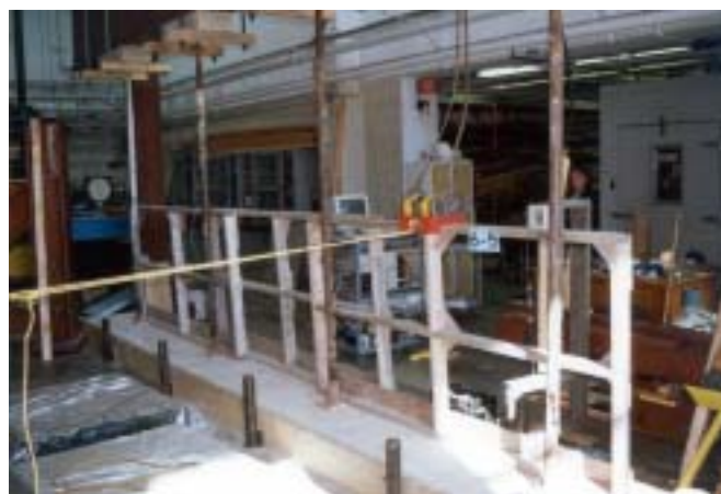
Figure B.19a) Essai 6-5 : Essai statique sur la lisse supérieure de la section de rive d'une suite de trois sections de garde-corps
