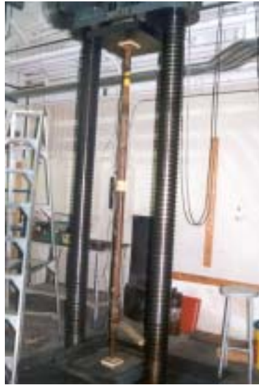
Figure 38 : Calibrage d'un étau métallique avec la presse Amsler
