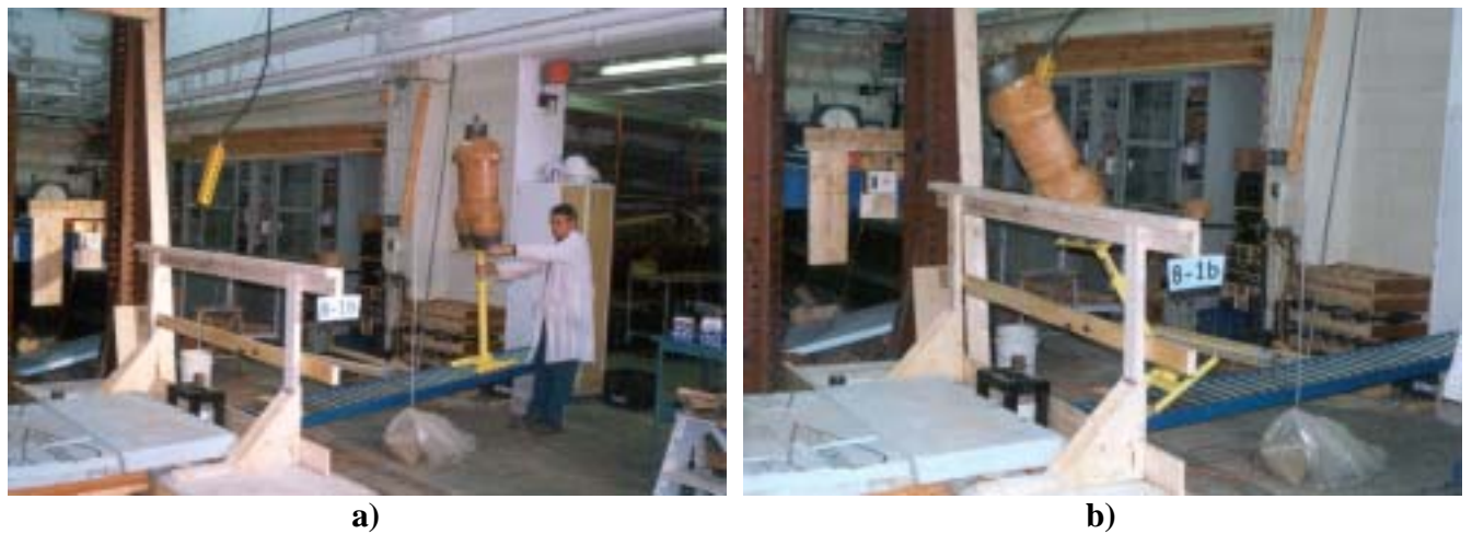
Figure B.25 Essai 8-1a : Essai de basculement avec la lisse supérieure en bois à une hauteur de 1.1 m
