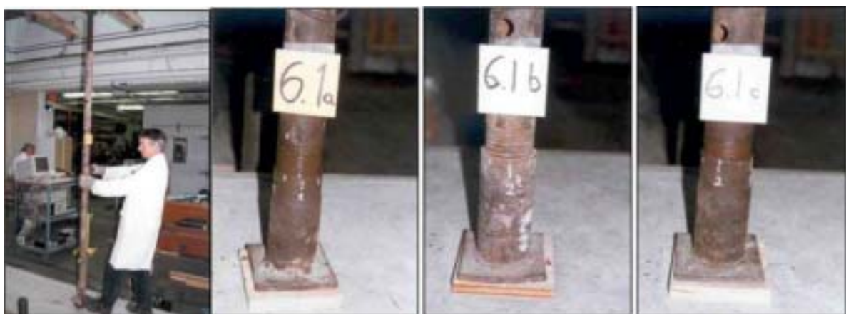
Figure 40 : Réalisation des essais 6-1a, 6-1b et 6-1c sur un étau métallique
