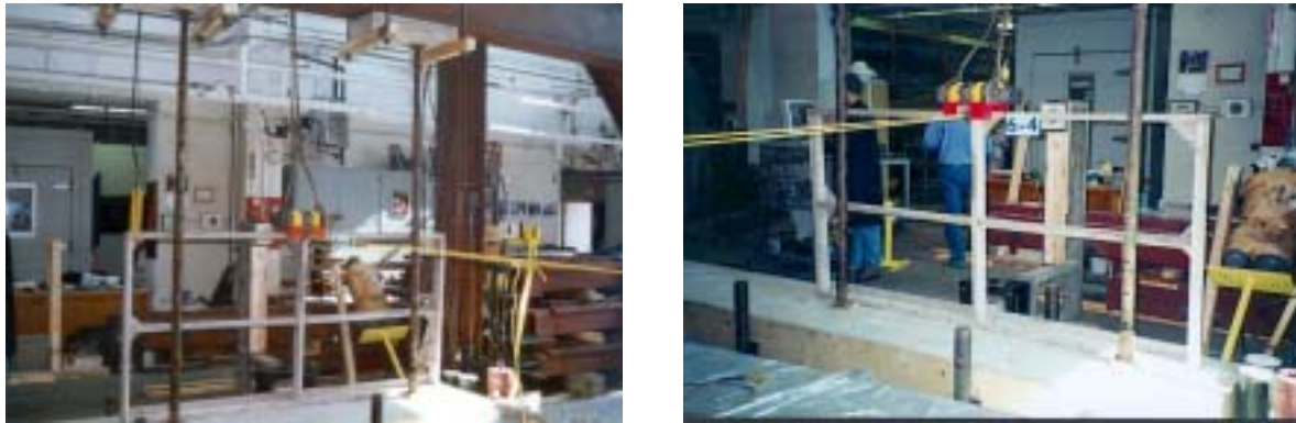
Figure 45 : Essai statique sur un garde-corps en bois
