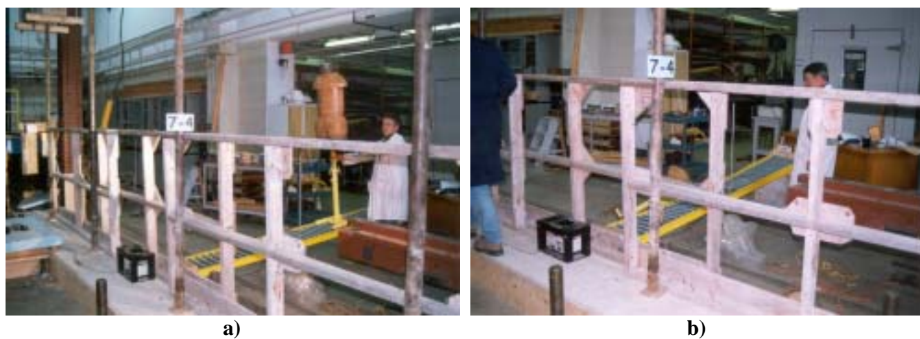
Figure B.23 Essai 7-3 : Essai dynamique sur la lisse supérieure de la section de rive d'une suite de trois sections de garde-corps en bois
