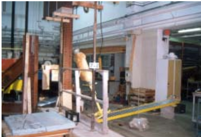
Figure B.21 Essai 7-1 : Essai dynamique sur un étau métallique (garde-corps en bois)
