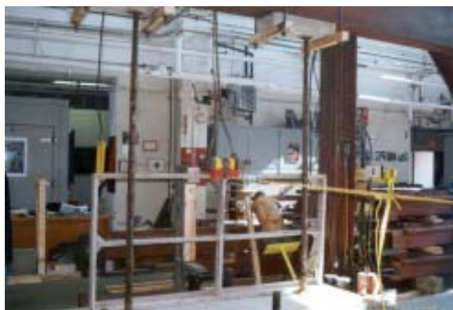
Figure B.18 Essai 6-4 : Essai statique sur la lisse supérieure d'une section de garde-corps
