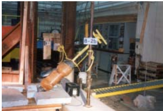
Figure B.29 Essai 8-2b : Essai de basculement avec lisse supérieure composée d'un câble de polypropylène situé à une hauteur de 1.0 m
