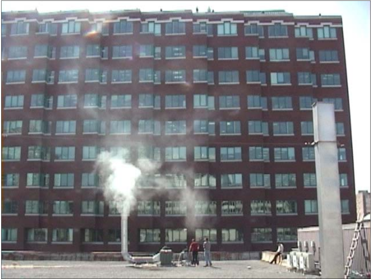
Figure 5.31 Test de fumée pour l'essai sur le terrain de l'heure 2 du 06 sept. 02 : emplacement de cheminée 3.
