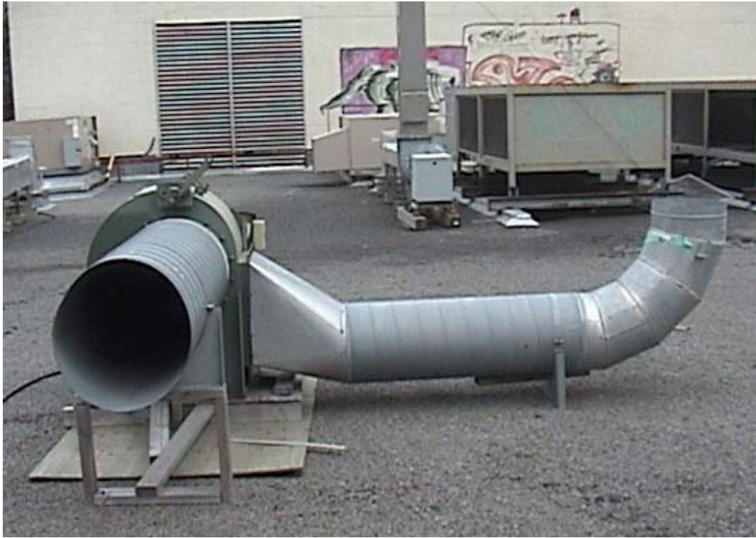
Figure 4.8 Photo de la cheminée d'essai installée sur le bâtiment BE (cheminée basse – h_s = 1 m).
