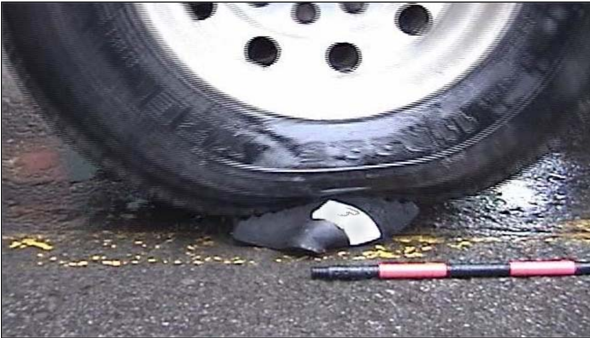
Figure 10. Cale écrasée sous le poids de la roue du camion
