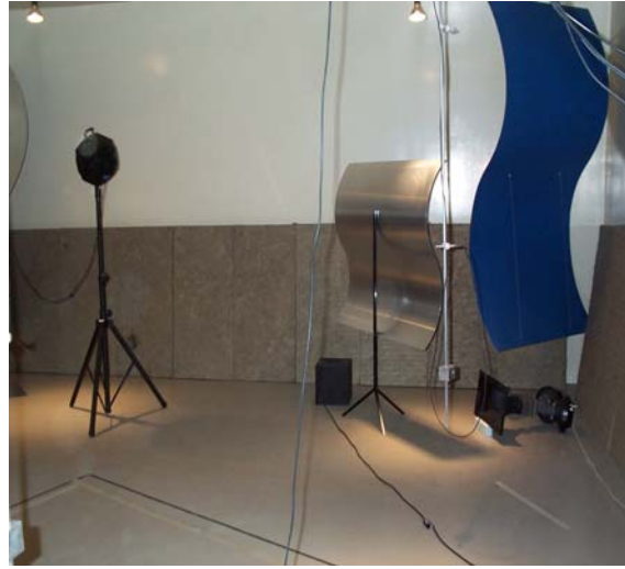
Figure 39: Photos du traitement partiel des murs de la chambre réverbérante avec de la laine de roche RHT100 homogène
