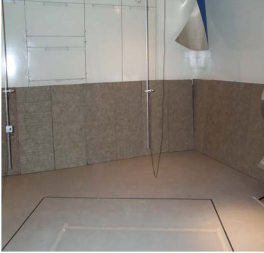
Figure 39: Photos du traitement partiel des murs de la chambre réverbérante avec de la laine de roche RHT100 homogène
