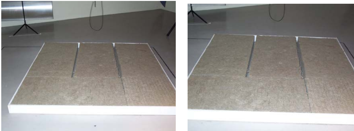
Figure 45: Illustrations de macro-porosité obtenues à l'aide de fentes
