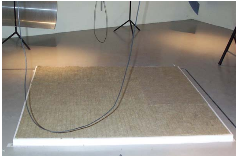
Figure 30: Vue de la surface de matériau traité pour la mesure de coefficient d'absorption en champ diffus.
