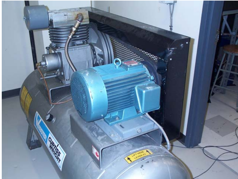
Figure 4 – Le compresseur utilisé comme source de bruit
