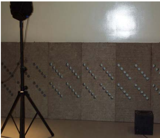
Figure 40: Photos du traitement partiel des murs de la chambre réverbérante avec de la laine de roche RHT100 à 5 % de double porosité
