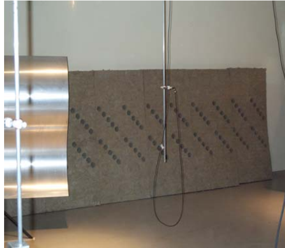
Figure 40: Photos du traitement partiel des murs de la chambre réverbérante avec de la laine de roche RHT100 à 5 % de double porosité
