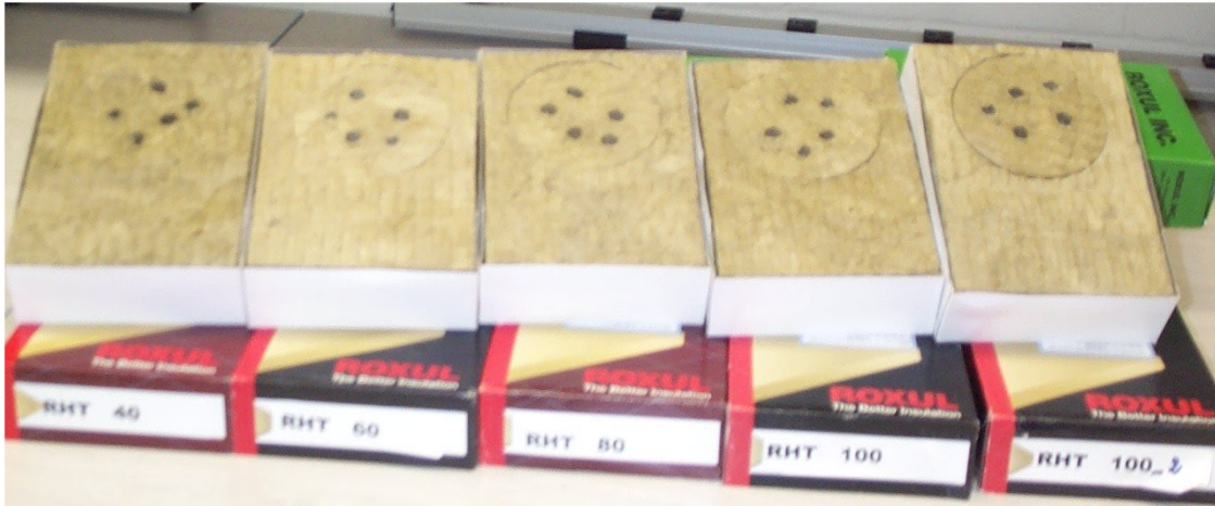
Figure 14: Les 5 différentes sortes de laine minérale RHT sur lesquelles on a testé l'effet de macro-perforation sur l'absorption
